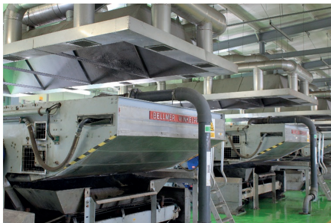
Rys. 11.9. Instalacja odwadniania osadów ściekowych
